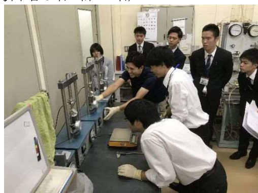
(一軸圧縮試験実習状況)
